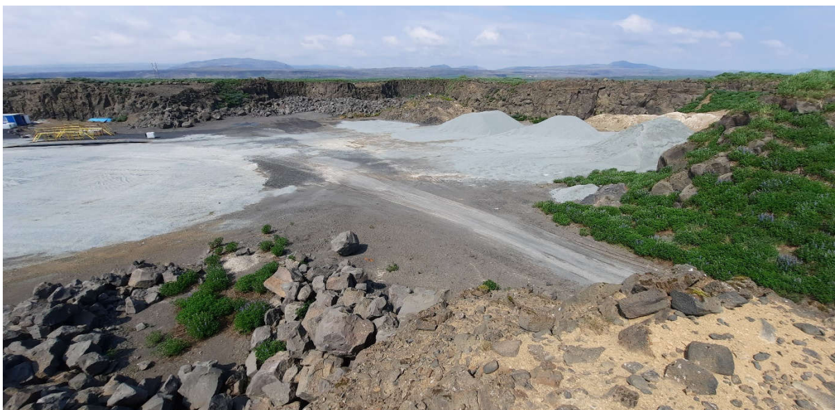
Mynd 8: Horft til norðurs yfir austur hluta námu E13 (Hafnarsandur). Á þessu svæði er bergið almennt stórstuðlaðra og hentugra til þess að vinna grjót í brimvarnargarða.
