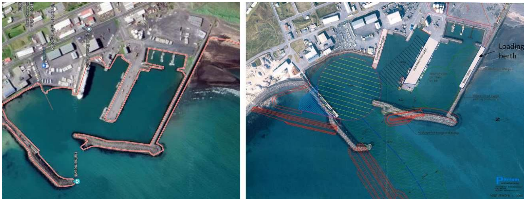
Mynd 3.2 Möguleg útfærsla á breytingu núverandi hafnar við Þorlákshöfn (valkostur 1). Mynd til vinstri sýnir Þorlákshöfn í dag og mynd til hægri framtíðarmöguleika. Sjá má viðlegukant, aðalgarð og þvergarð ásamt athafnasvæði skipa innan hafnarinnar.
