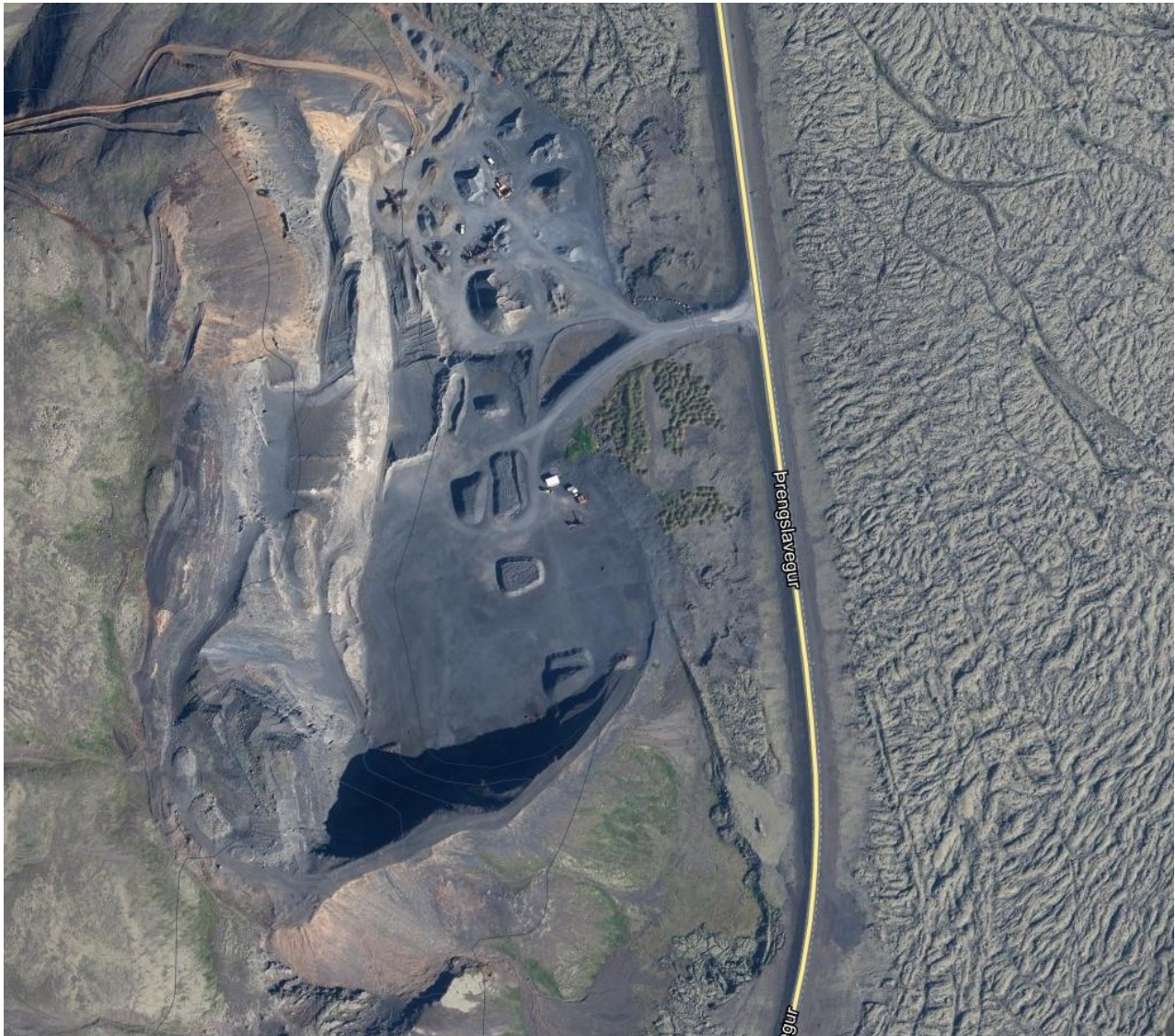
Mynd 4 Engin ummerki um fok sjást við námuna í Lambafelli þrátt fyrir áratugalanga efnistöku. Þrengslavegur fer alveg upp við námuna án þess að verða fyrir neinum áhrifum af efnisfoki. Þrengslin og Bláfjallasvæðið eru auk þess á úrkomusömu svæði sem virkar sem náttúruleg rykbinding og norðanáttir eru algengastar á veturna þegar úrkoma er einmitt hvað mest.
